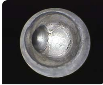
Prüfung von Position und Entgratung in einem Düsenkörper im Fertigungsprozess
