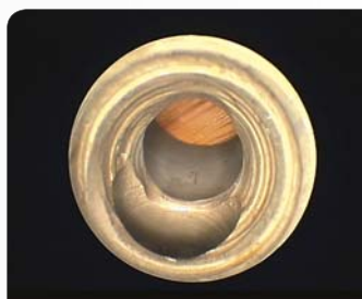
Schlecht zentrierter Bohrungsübergang in einem Pumpengehäuse
