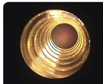
Gut geschnittenes Innengewinde in einer Hohlwelle für Präzisionsuhren
