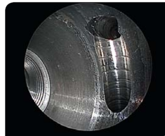
Prüfung einer Bohrungsverschneidung hinsichtlich Grاتفreiheit
