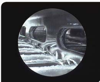
Gratbildung an einem Lüftungsblech nach dem Stanzprozess
