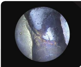
Auslauf einer Schweißnaht
